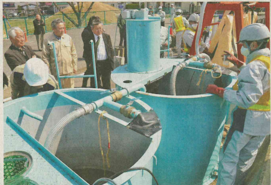
側溝にたまった汚染土壌を洗浄した新システムの実証実験
